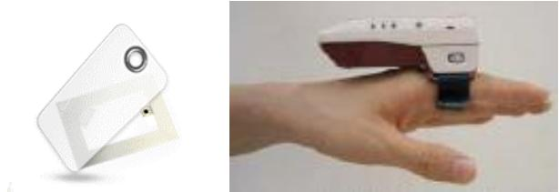
Figure 3. IC tag and IC tag Reader
