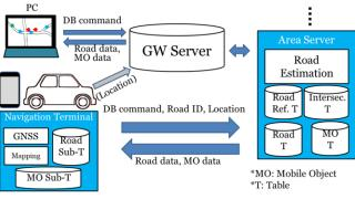
Figure 3. Configuration of TDMS
